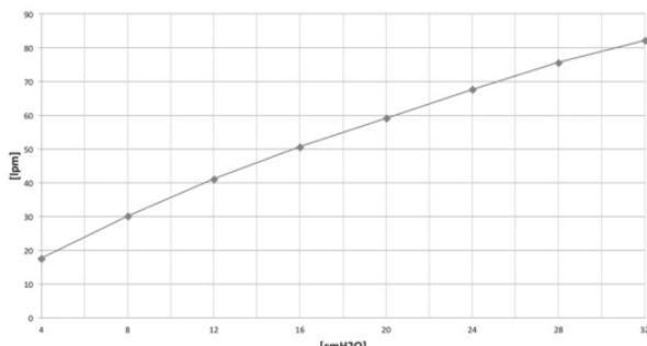
**Примечание:** вследствие технологического разброса параметров при изготовлении скорость потока воздуха через маску может различаться от маски к маске ( $\pm 10\%$ ).
